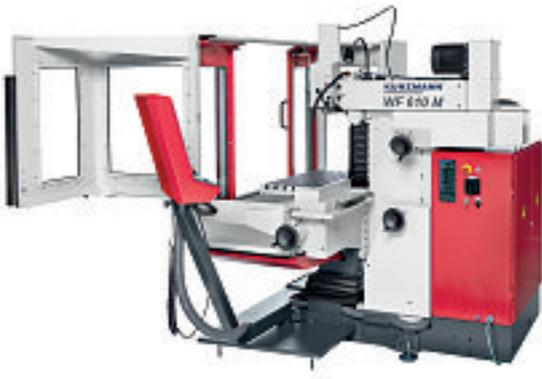
Beim manuellen Fräsen wird mitunter ein offener Arbeitsraum gewünscht. Voraussetzung hierfür ist jedoch, dass alle Betriebsarten ein sicheres Arbeiten erlauben.
